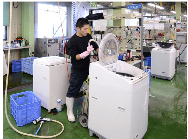
▲【(株)シー・アイ・シー】洗濯機洗浄再生工程
