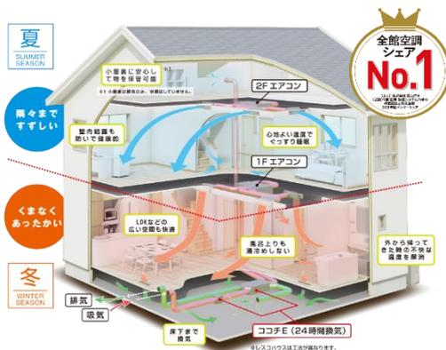
『Z空調』は、ヒノキヤグループの連結子会社(株)日本アクア (<https://www.n-aqua.jp/>) が提供する断熱材『アクアフォーム』で建物の断熱・気密を高め、空調をダイキン工業(株)、換気を協立エアテック(株)が担うことで実現した、快適で経済的な新冷暖房システムです。独自技術により従来の全館空調の導入コストを大幅に下回る販売価格と壁掛けルームエアコン同等の電気代を実現した冷暖システムです。24時間365日、家中どこでも快適な温度を維持することができ、導入されたお客様からも非常に高い評価をいただいています。2016年12月に発売を開始し、2017年には特許を取得。2017年度グッドデザイン賞 (主催：公益財団法人日本デザイン振興会) も受賞しました。
