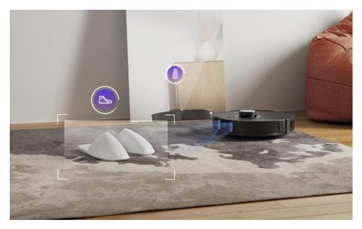
また、毎分300回転する高精度レーザーセンサーが部屋を掃除しながら360度スキャンすることで、部屋を素早くマッピングし、独自のアルゴリズムとともに効率的なルートで掃除を行います。さまざまなセンサーが連携し、家具や障害物を検知して、段差からの落下や家具への挟まりを回避しながら部屋の中を隅々までスムーズに移動することができます。
