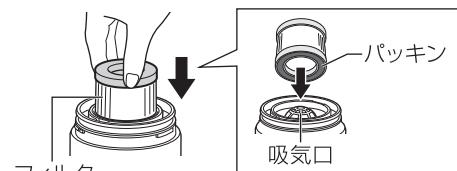
**2** フィルターケースの凸部を本体の凹部に合わせてはめ込み、矢印の方向に回す
