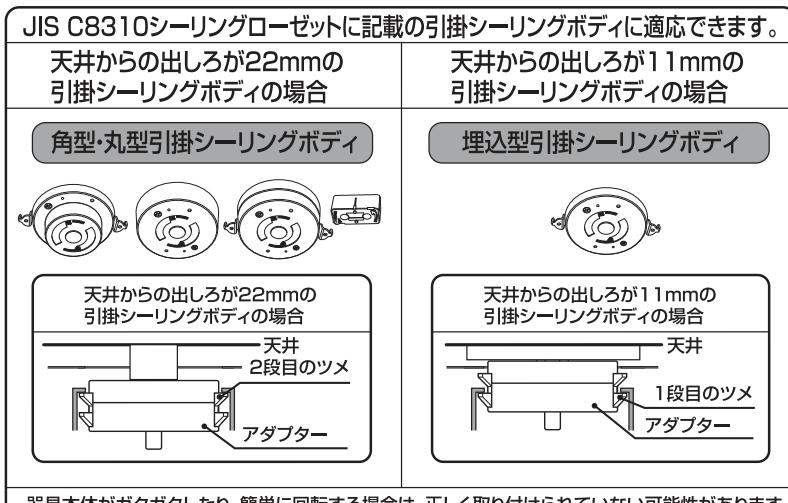
器具本体がガタガタしたり、簡単に回転する場合は、正しく取り付けられていない可能性があります。再度、器具の取り付けを行ってください。
