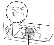
圧縮機(コンプレッサー)
