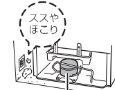
圧縮機(コンプレッサー)
