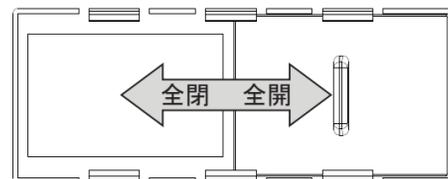
冷凍室ダンパーは冷蔵室ダクト左上にあります。通常は 冷凍室ダンパーは全開でお使いください。冬場など周囲温度が低く(約10度以下が続く場合)、冷凍室の冷えが弱い場合に、ダンパーは閉めてください。
