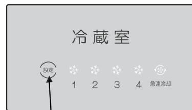
冷蔵室温度設定ボタンを押すと、設定位置を示すランプ(点灯)が移動します。右表を目安に設定してください。
