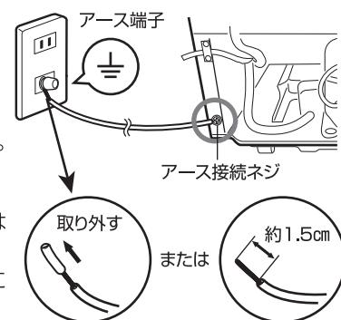
**ご注意** 水道管やガス管、電話線のアースや避雷針には接続しないでください。水道管やガス管に接続すると
