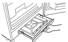
蒸発皿を冷蔵庫底部に必ず取り付けてください
