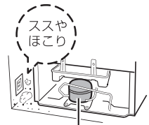
圧縮機(コンプレッサー)
