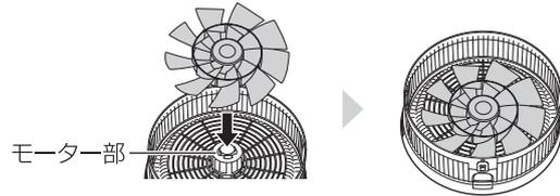
② 羽根キャップを「
