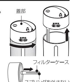
3.フィルターケースの中から古いフィルターを外して付属の交換用フィルターに交換し元通りにしっかりと差し込みます。
